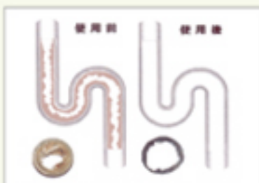
尿石がパイプに付着して詰まりかけている 尿石が黒くなり分解されて詰まりが解消されている
